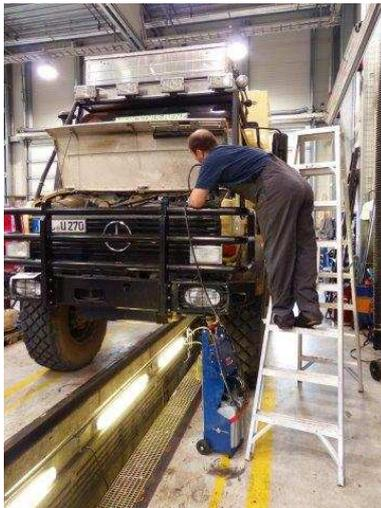
Der Kupplungsgeberzylinder wird ausgebaut und sieht noch gut aus. Das Kupplungssystem wird an zwei Stellen gelüftet.
